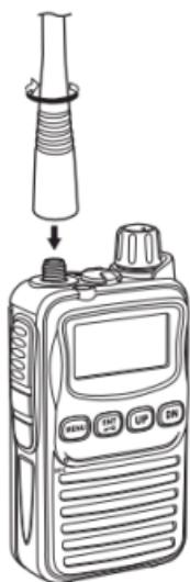
Для снятия антенны необходимо отвернуть её против часовой стрелки.
