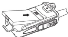
Затем установить крышку аккумулятора, совместив её выступы с салазками на шасси и подать её вперёд до полного защёлкивания. Фиксатор переместить вверх.
