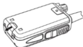
Подать крышку аккумулятора назад и снять её. Аккуратно вытащить аккумулятор.
